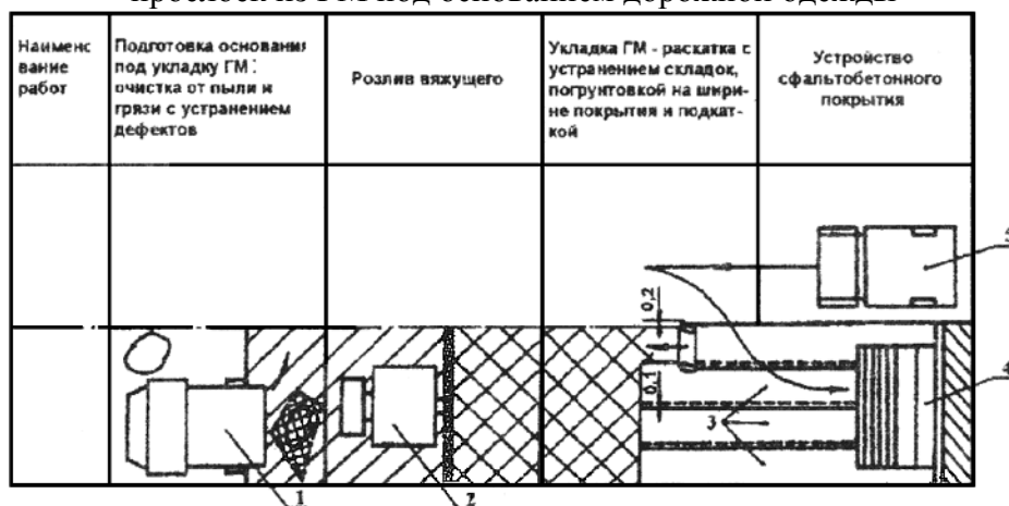
Рисунок 9.10 – Технологическая схема по устройству защитно-армирующих защитных прослоек из ГМ под основанием дорожной одежды
